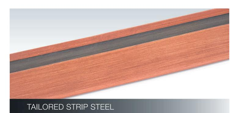
Ob gleiche oder verschiedene metallische Werkstoffe: Wir verschweißen für Sie die unterschiedlichsten Abmessungsvarianten. Bis zu drei Bänder mit einer maximalen Gesamtbreite von 100 mm werden endlos zum Spezialband Ihrer Wahl verbunden.
