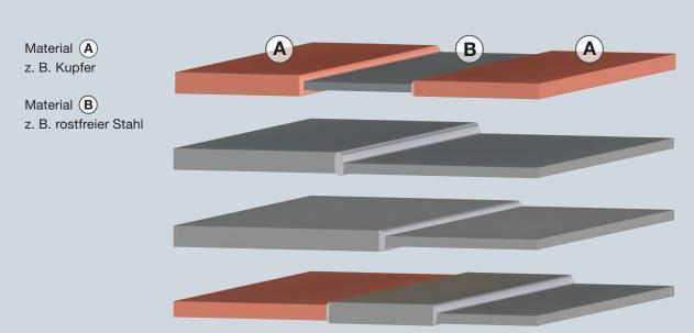
Tailored Strip Steel ermöglicht die einzigartige Kombination verschiedener materialspezifischer Eigenschaften. Gleichzeitig bietet es Potenzial zur Kostenreduzierung, denn hierbei werden hochpreisige Werkstoffe durch günstigere Materialvarianten ersetzt.
